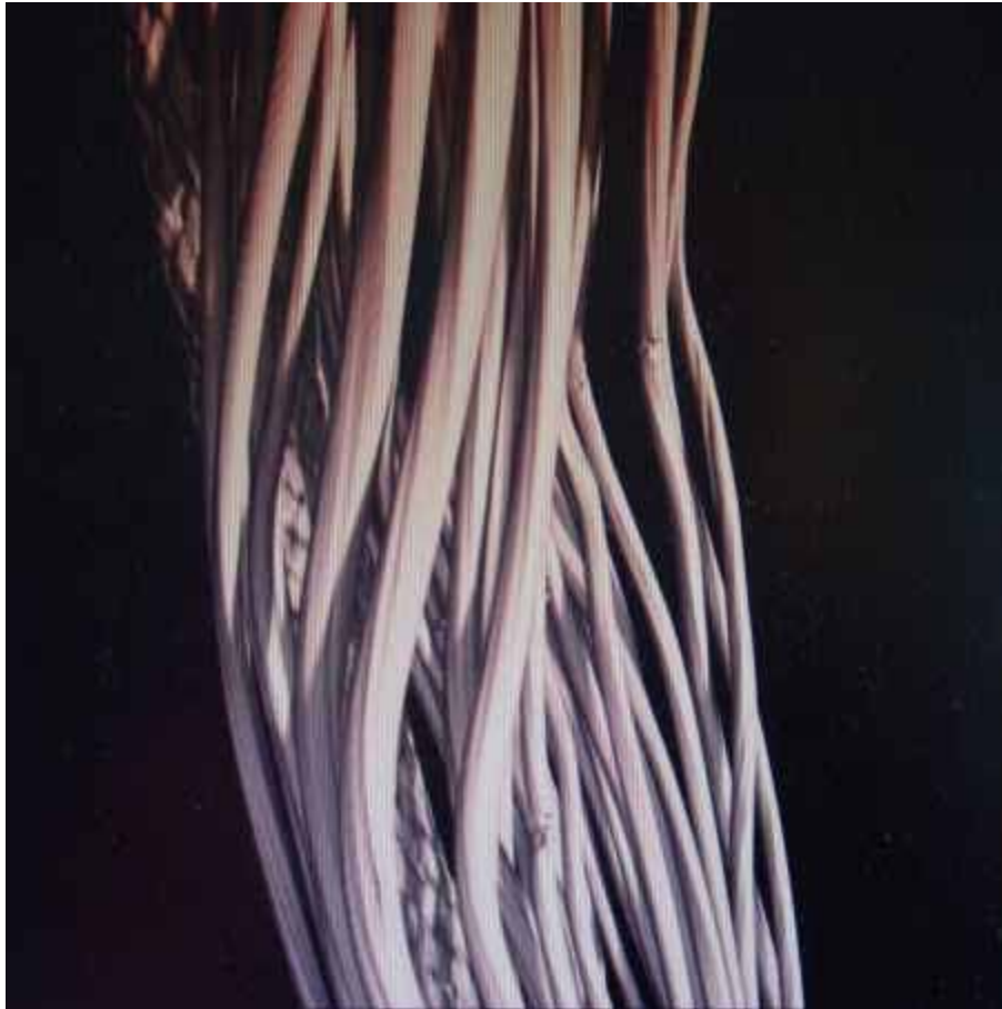
3D Scan eines Kabelsatzes
