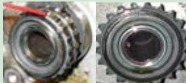
Früher Verschleiß: abgenutztes Kettenrad (links), Neuteil (rechts)
