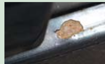
Pflegefall: Korrosion im Einstiegsbereich von Schuchardts A6
